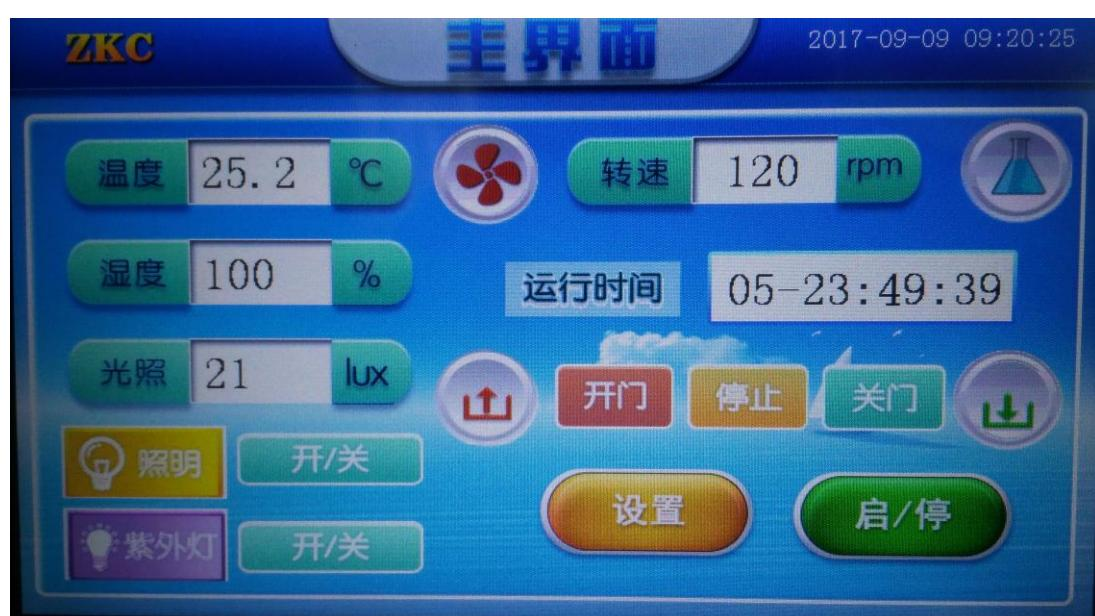
**此设备为电动门设计，使用面板上的开门和关门按钮才能打开箱门。**
